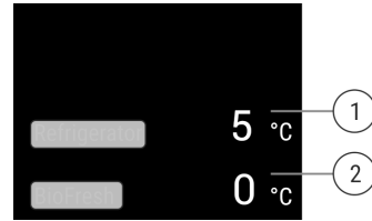
Fig. 9 Statusanzeige zeigt Ist-Temperatur.*
