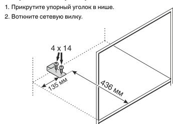
3. Перед встраиванием в кухонный шкаф прикрутите к прибору прилагаемый укрепляющий профиль винтами M4 x 8.
