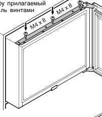
Задвиньте прибор в нишу настолько, чтобы расстояние между корпусом шкафа и передней стороной двери составляло 21 мм.
